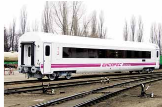
Дослідний пасажирський комбінований вагон, мод. 61-788
