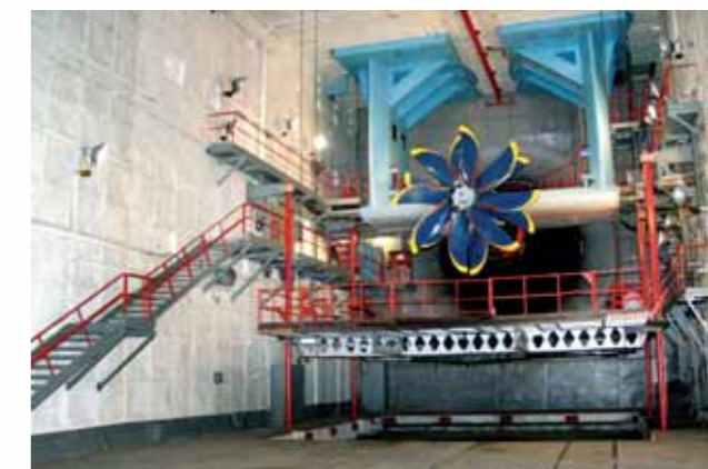
Турбогвинтовентиляторний двигун Д-27 на випробувальному стенді
